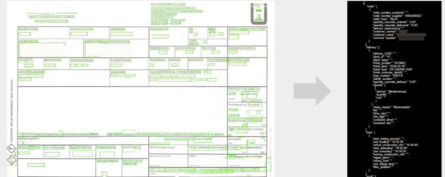
Bild 1. Lieferschein mit den durch OCR erkannten Daten (links), die Daten im json-Format (rechts)
