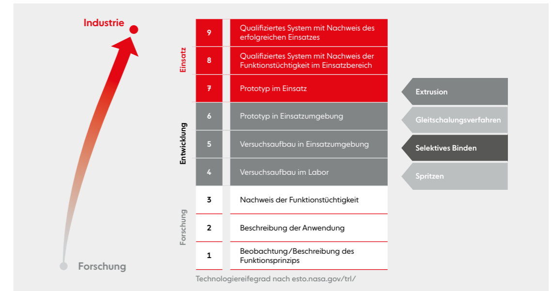
Bild 1. Schema des Technologiereifegrades (TRL) und die vier bekanntesten Fertigungsverfahren. Die Zuordnung des TRL soll für jedes Fertigungsverfahren und für jede konkrete Anwendung ermittelt werden.
